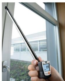
Exemple d'utilisation sur un châssis non étanche : l'appareil mesure 0.9 m/s. Si le châssis était étanche, il devrait mesurer une valeur inférieure à 0,1.
