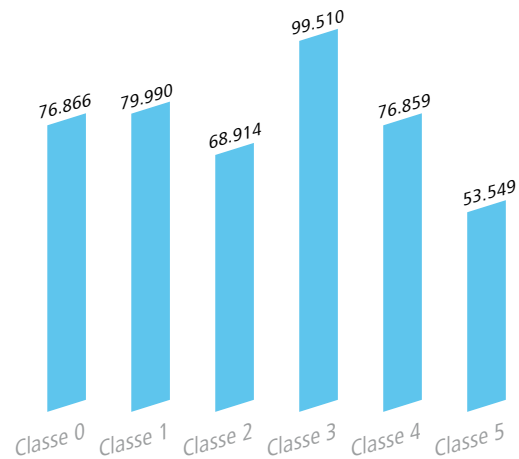
Longueur du réseau inspecté et analysé par classe de gravité entre 2008 et 2012 (en m)
