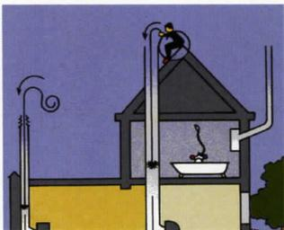
**La cheminée doit être ramonée.** Le ramoneur doit, si possible, monter sur le toit et brosser le conduit du haut vers le bas. Il doit aussi vérifier que la cheminée n'a pas de fissure.
