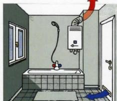
Le chauffe-eau de **10 litres** sera utilisé pour la **douche** et celui de **13 litres** sera utilisé pour la **baignoire**.
